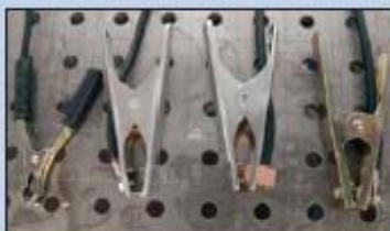
Держатели электродов и формовочные клещи тестируемых аппаратов (слева направо): Fimer, Rehm, Fronius и Lorch.
