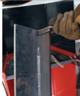
В процессе практического тестирования были сварены десятимиллиметровые стальные пластины из материала S235.
