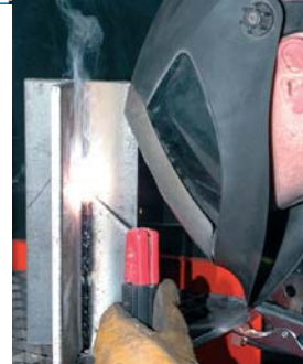
При тестировании были выполнены угловые швы в позиции PF (по вертикали снизу вверх) и PB (горизонтально).
