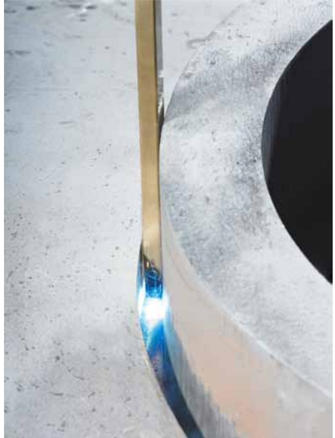
*Keine Nahtvorbereitung durch Engspalttechnik
